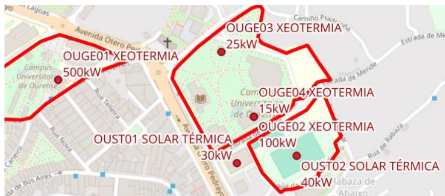
Ilustración 30. Instalacións renovables térmicas no campus de Ourense
