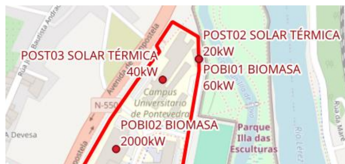
Ilustración 31. Instalacións renovables térmicas no campus de Pontevedra
